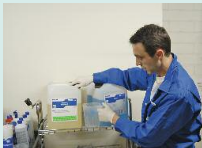
Wenn unter beengten Verhältnissen kein Dosierautomat installiert werden kann, ist auch dank des Messbechers eine exakte manuelle Dosierung möglich.
